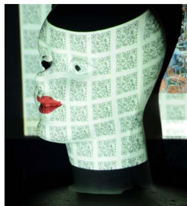
図 5 立体物への QR コードの照射（全体） (29×29 セル・2 倍モード, DC=255, AC=128)
